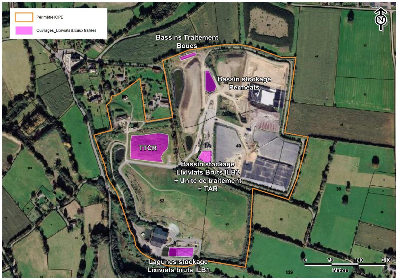
Figure 16 : Gestion des lixiviats bruts et eaux de process traitées – ILB 1 & ILB 2
